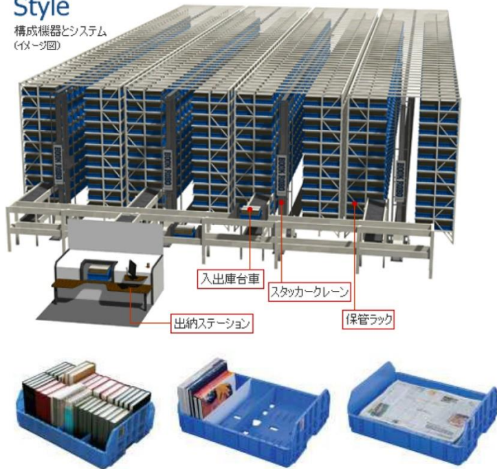
圖 28:ASRS 構造概念圖
